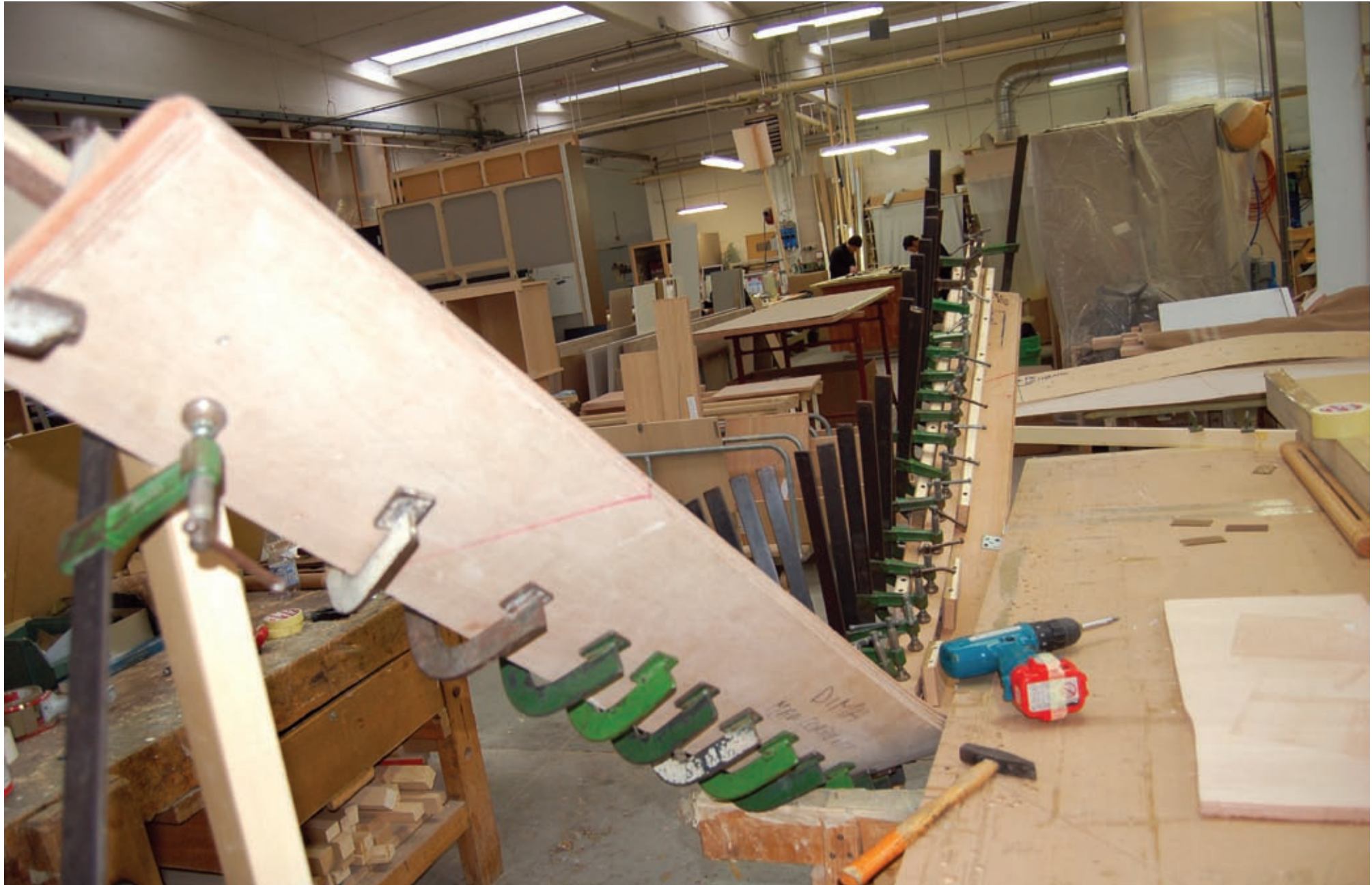
Il corrimano in costruzione / The handrail under construction
